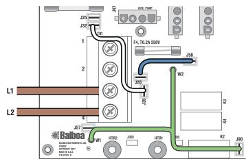
Fonctionnement simple, Systèmes èlectrique IT (sans neutre) Ligne - La tension de ligne est 230VAC (1x16A ou 1x32A) 3 conducteurs (2 phase, 1 prise de terre)
