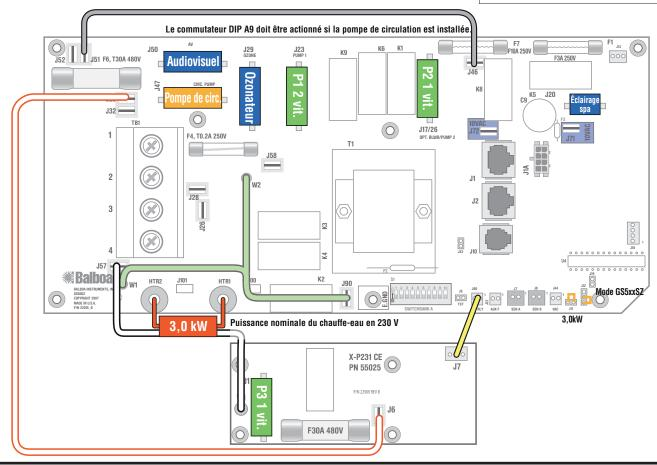
AVERTISSEMENT: L'alimentation principale au système doit être COUPEE AVANT de procéder aux configurations des commutateurs DIP. AVERTISSEMENT: La mémoire rémanente (J43) doit être REINITIALISEE pour permettre aux nouveaux réglages de commutateurs DIP d'être actualisés (se reporter à la page relative à la mémoire rémanente).
