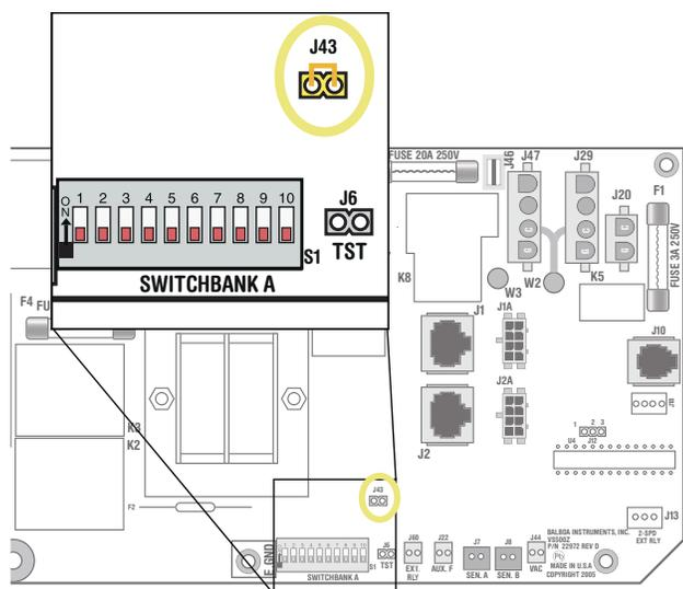
J43 en VS5xxZ y la Junta de la serie VS300 principal que se muestra.
