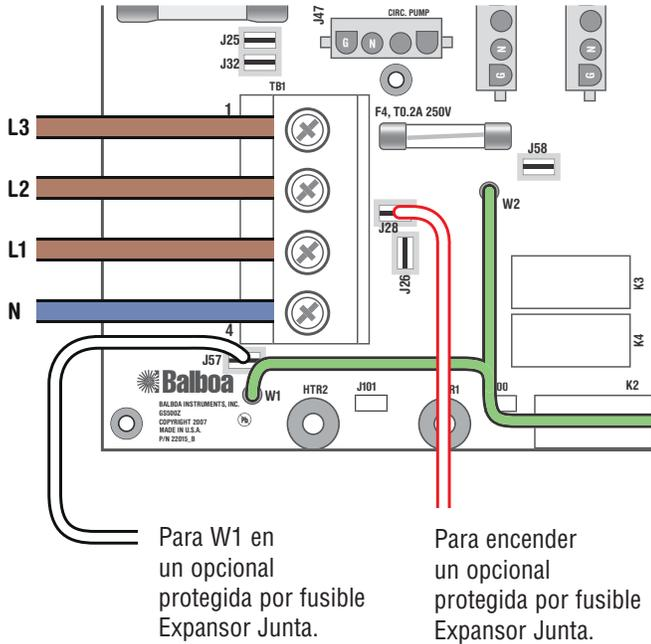
Para W1 en un opcional protegida por fusible Expansor Junta.
