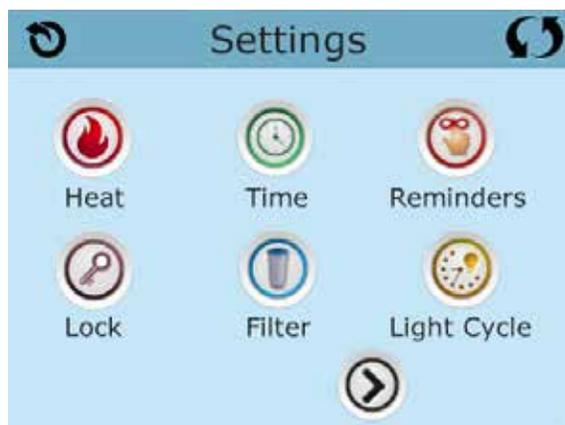
Das Symbol "Heizung"
