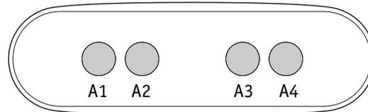
**Panneau Auxiliaire AX40 sur le branchement 1 fonctionnera A1 + A2, A3 et A4.**
