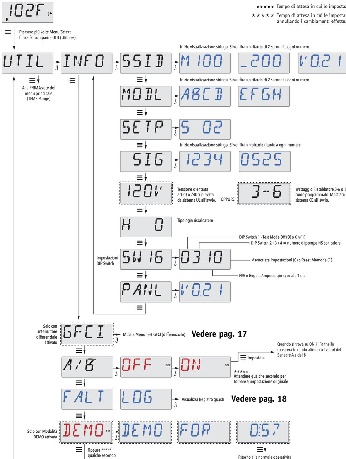
Queste stringhe sono visualizzate una sola volta per poi tornare all'inizio. Premere ancora Temperatura per visualizzare nuovamente la stringa.
