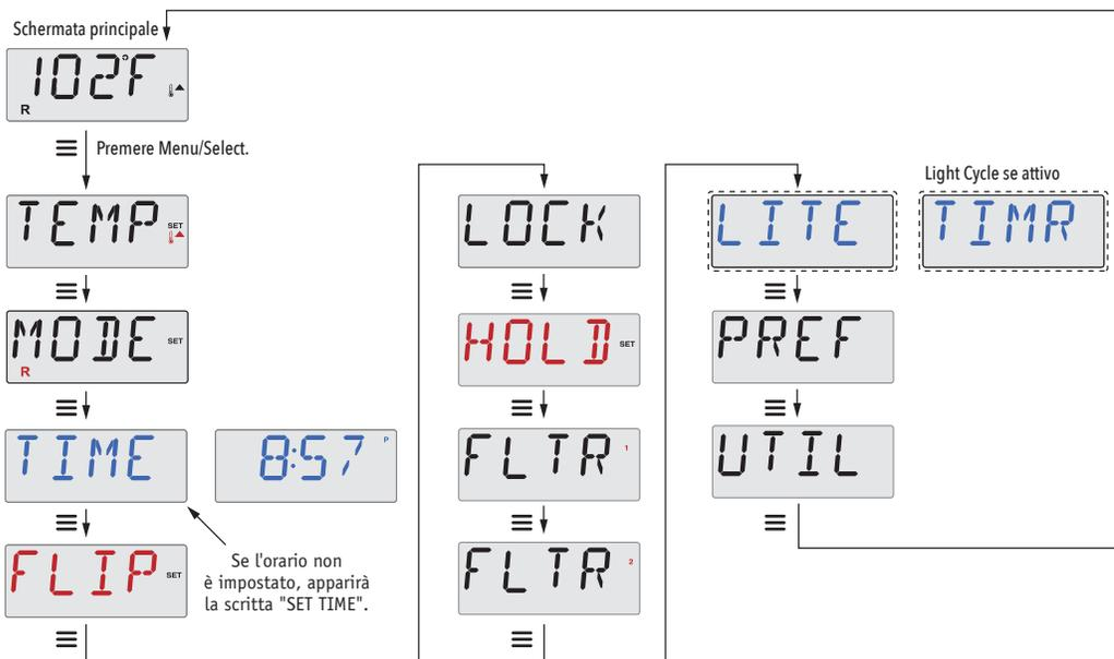
Indica una voce del menu che può comparire o meno a seconda della configurazione del produttore.
